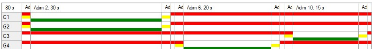
Şekil 2.27. ÇK11 kavşağı optimize devre diyagramı
