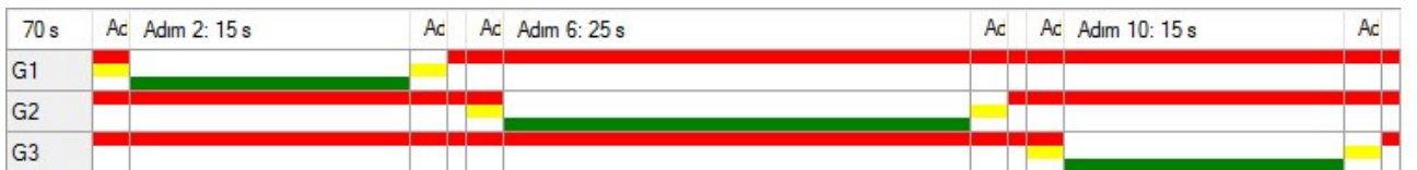
Şekil 2.42. ÇK24-02 kavşağı optimize devre diyagramı
