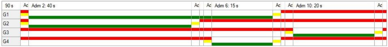
Şekil 5.21. ÇK 06-01 kavşağı akşam devre diyagramı
