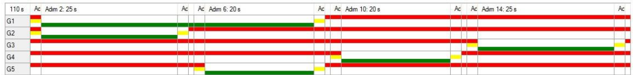
Şekil 5.53. ÇK 14 kavşağı öğle-akşam devre diyagramı
