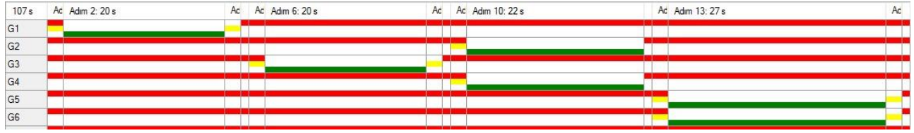
Şekil 5.4. ÇK 01 kavşağı akşam devre diyagramı
