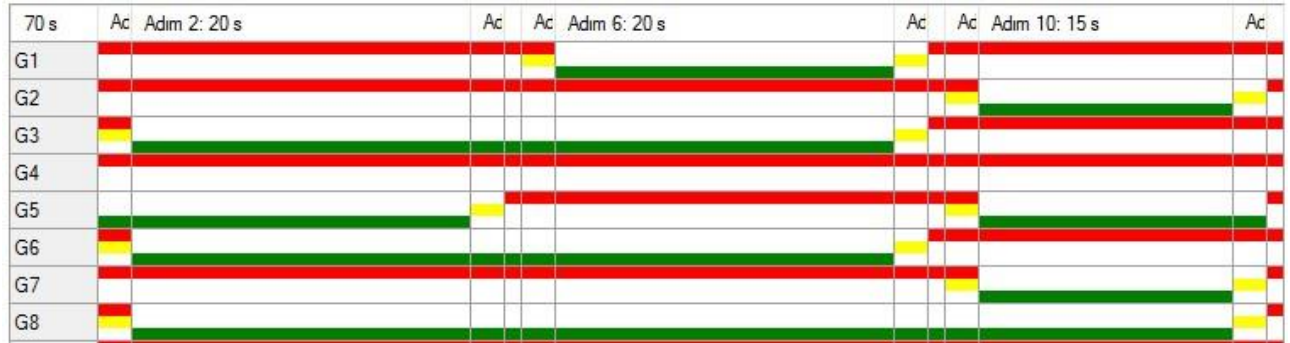
Şekil 5.8. ÇK 02 kavşağı akşam devre diyagramı
