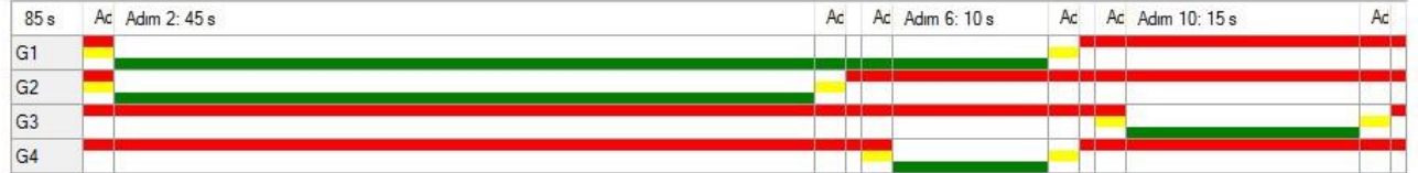
Şekil 5.24. ÇK 06-02 kavşağı öğle-akşam devre diyagramı
