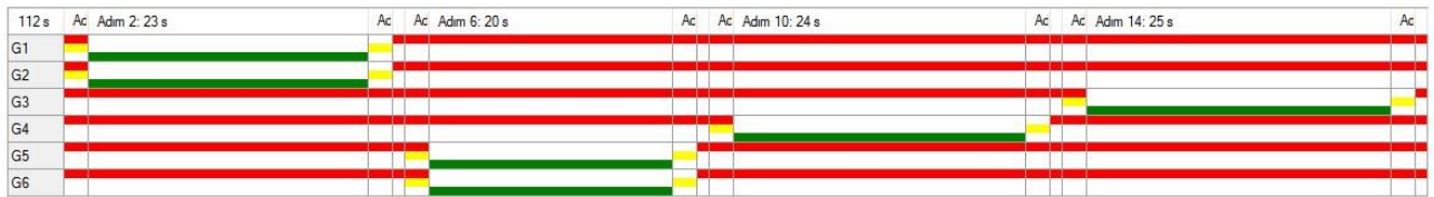
Şekil 5.44. ÇK 09 kavşağı akşam devre diyagramı
