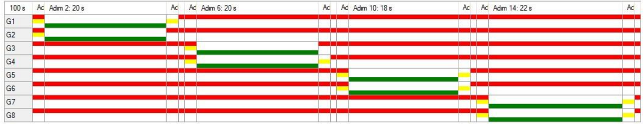
Şekil 5.35. ÇK 08-01 kavşağı öneri 2 durum öğle devre diyagramı
